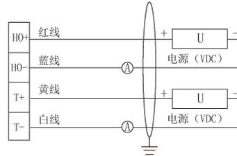
代表屏蔽线，所标注接地点须全部有效接地。建议选用带屏蔽双绞信号电缆。为了避免接地回路，屏蔽层采用单端接地，在变送器端绝缘浮地，并在控制柜端接地。
